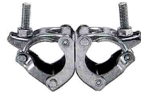
兼用自在クランプ C-KF (48.6φ・42.7φ×48.6φ・42.7φ) ●許容荷重…3.43kN ●質量…0.74kg (350kg)
