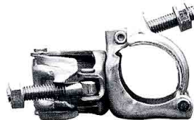
異径直交クランプ C-EC (48.6φ×42.7φ) ●許容荷重…4.90kN ●質量…0.69kg (500kg)
