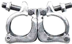
自在クランプ C-48F (48.6φ×48.6φ) ●許容荷重…3.43kN ●質量…0.7kg (350kg)
