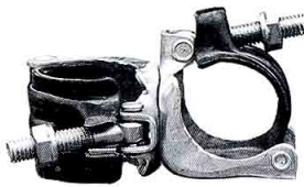
直交クランプ C-48C (48.6φ×48.6φ) ●許容荷重…4.90kN ●質量…0.72kg (500kg)
