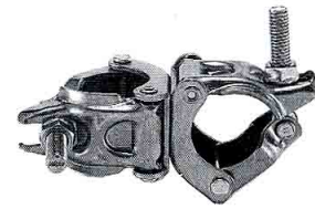
兼用直交クランプ C-KC (48.6φ・42.7φ×48.6φ・42.7φ) ●許容荷重…4.90kN ●質量…0.75kg (500kg)
