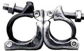
異径自在クランプ C-EF (48.6φ×42.7φ) ●許容荷重…3.43kN ●質量…0.65kg (350kg)
